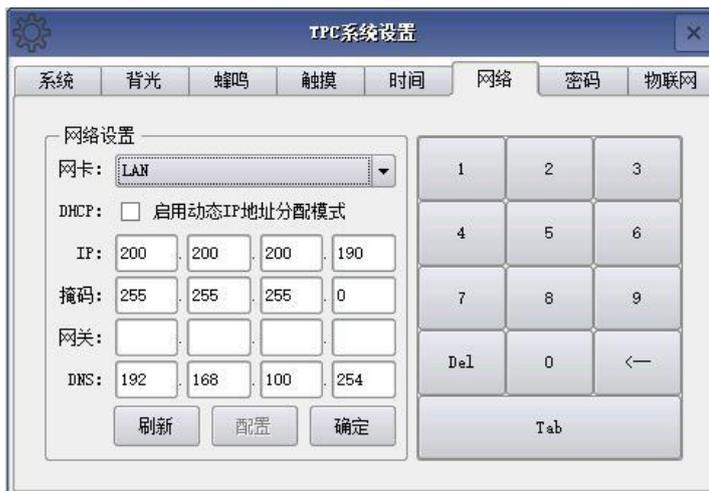
注意：这种情况下上外网，要手动输入 DNS 为 8.8.8.8 或者 114.114.114.114。但是如果选择的是启动动态 IP 地址分配模式，就没法手动输入啊，400 客服说，先不勾选，手动输入后点确定，再勾选。真是很厉害的操作。不这样操作，在物联网标签页点上线的时候，可能会提示“上线启动失败”。如果遇到这种提示，再次输入 DNS 试试。
