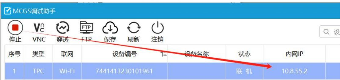
再点“VNC”，输入 VNC 密码（和物联网屏的“系统设置-物联网标签页-VNC 密码”一致），就能打开屏幕画面了，实现远程控制。
